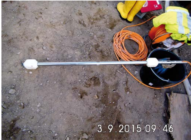
Bild 11 Messsonde NMGD 30/2 Measuring sensor NMGD 30/2
